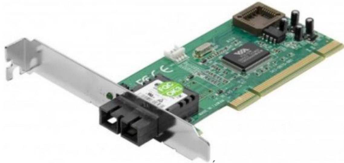
Tarjeta de red PCI Fibra Óptica 100FX SC+Low Profile+WOL
